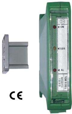
IL Trigger T-BOX-MDL permette di realizzare un gruppo statico monofase AC-Switch con attivazione programmabile sia ZERO-CROSSING che ad ANGOLO DI FASE. Viene fornito con il supporto angolare a guida DIN che per l'applicazione al corpo dissipante composto dal semiconduttore ed eventuale fusibile e Snubber. Viene alimentato a 24V dc e può essere attivato selezionando un segnale SSR compreso da 11 a 24V dc 2mA o analogico 0-10V, 4-20mA. E' dotato di diagnostica rottura carico/fusibile e avaria SCR.
